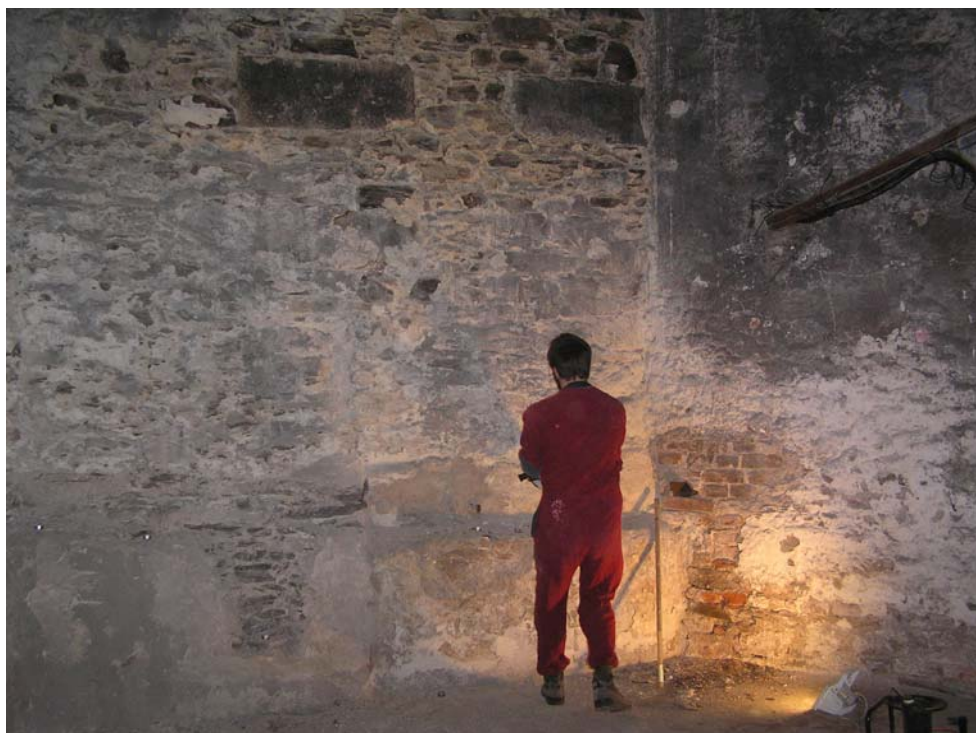
Foto 6: Přízemí, vrt pro zjištění existence dutiny za stěnou u hlavního schodiště, příp. schodišťového ramene z přízemí do 1. patra, vrt 1 – viz Příloha 4.1, sonda P4
